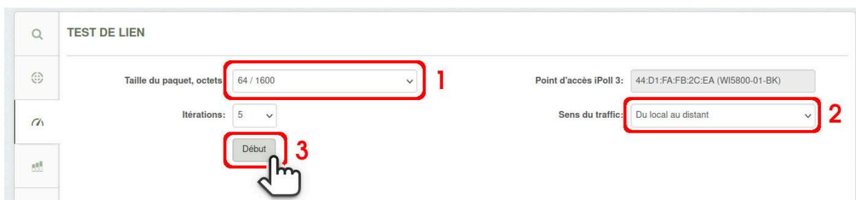
FIGURE 46 – Paramétrage et démarrage du test de débit
