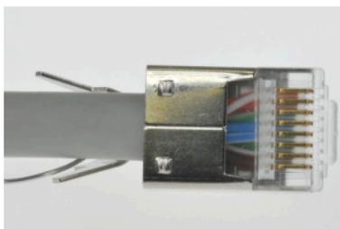
8. insérer le câble équipé du peigne dans le connecteur. Le peigne restant à l'extrémité des conducteurs et venant complètement sous les contacts.
