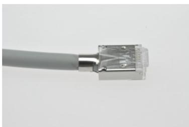
14. agrafer le drain de masse le long de la bague de reprise de masse.
