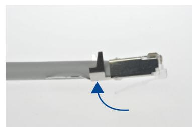
9. aligner la reprise de masse avec le corps du connecteur. Mettre le drain sur le dessous.
