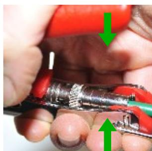
14. Comprimer la BNC jusqu'à disparition du joint arrière
