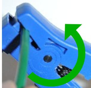
2. Tourner le dénudeur dans le sens indiqué par la flèche jusqu'à ...
